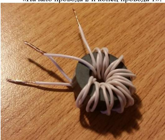
4. Разместить полученную конструкцию на основной плате УМ. Рекомендуется приклеить дроссель горячим клеем к плате для фиксации конструкции.
