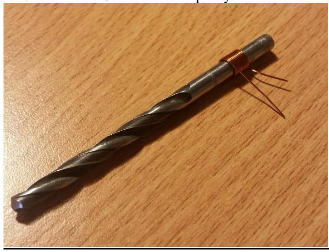
3. Снять намотку с оправки и убедиться в симметричности и равномерности конструкции. Сделать вторую намотку L2.
