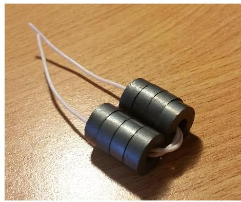
3. Намотать 3 витка вторичной обмотки тем же проводом.
