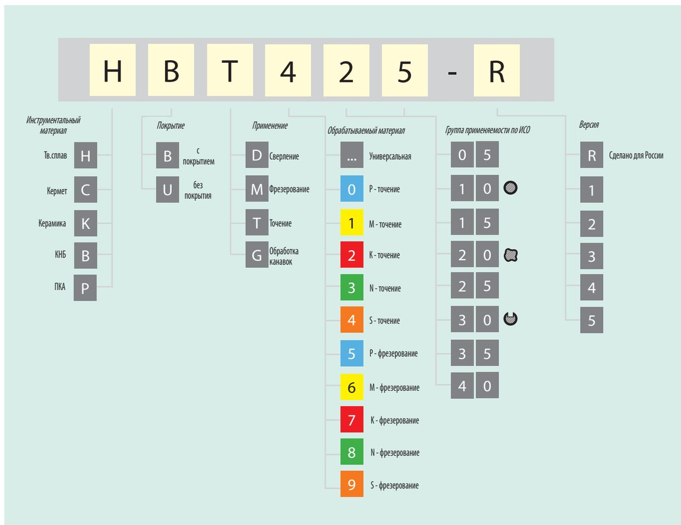
Система обозначения стружколомов HOLEX-R
