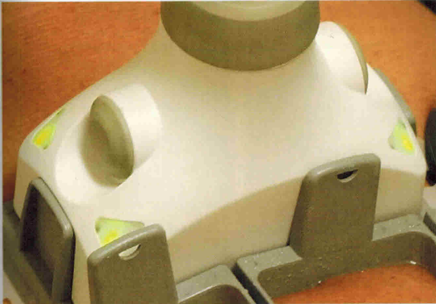
Рис. 3.4 Схема установки лазерного зонда в аппликатор. Обратите внимание, что при полном контакте с кожей все индикаторы зонда горят зеленым цветом. При некорректной установке зонда в аппликаторе лазер не активируется. (Изображение любезно предоставлено корпорацией Synosure.)
