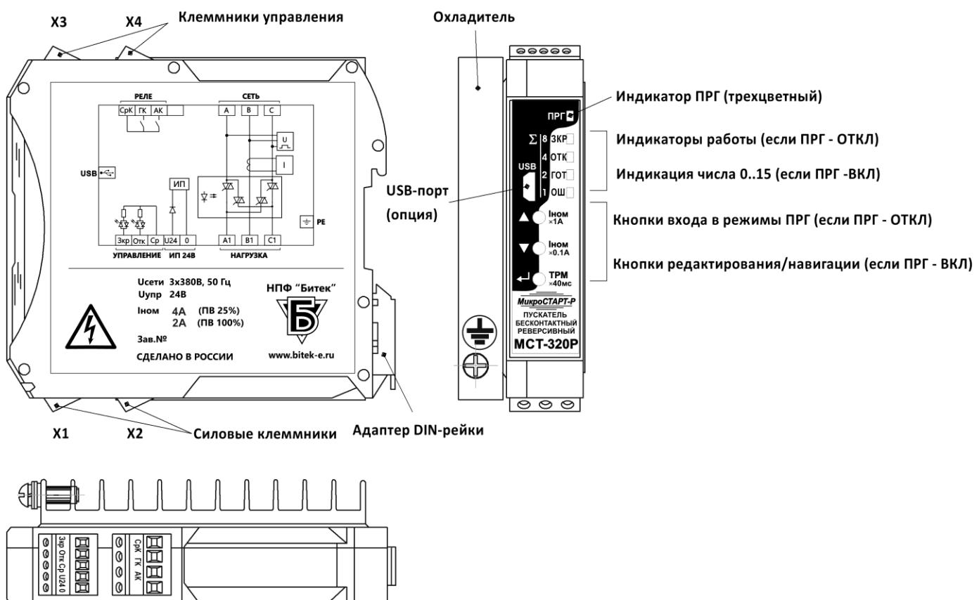
Рисунок 1 - Внешний вид пускателья МСТ-320Р-USB
