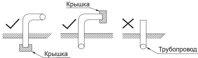
2. При подаче трубы через отверстие в стене обязательно одевайте заглушку на конец трубы.
