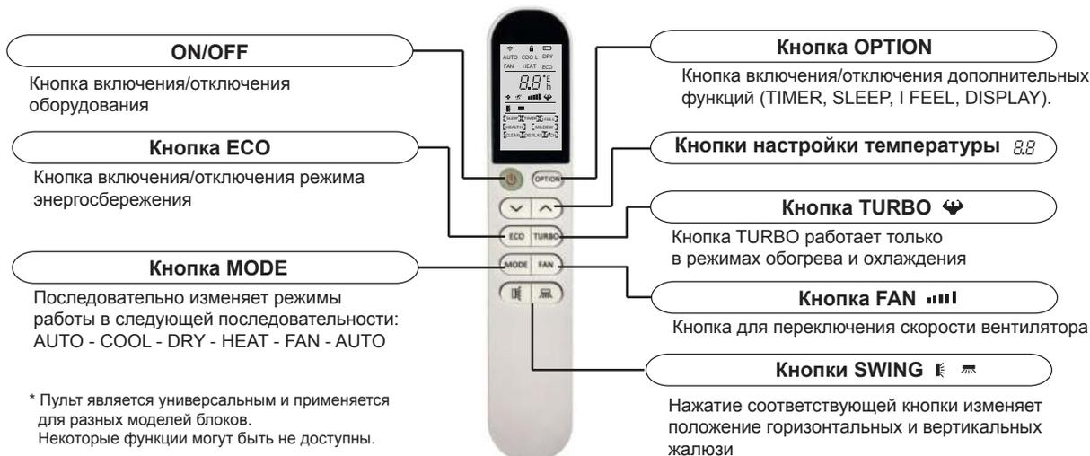
Для включения блока направьте пульт управления на блок. Затем нажмите кнопку **ON/OFF**. И установите требуемый режим работы кнопкой **MODE**. Каждое нажатие будет переключать блок на следующий режим работы: **AUTO-COOL-DRY-HEAT-FAN**. Кнопками **▲▼** установите желаемую температуру в помещении в диапазоне от +16 до +30 °C.
