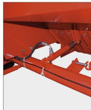
Гидравлика подборщика позволяет управлять подборщиком из кабины трактора.
