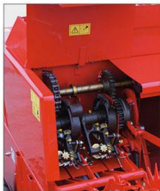
Машина оборудована надежным вязальным аппаратом Raaspe.
