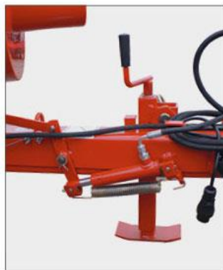
Гидравлически регулируемое дышло облегчает установку рабочего или транспортного положения агрегата.
