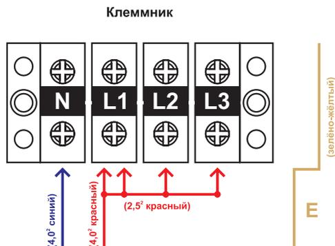
Для 400 В используйте пятижильный кабель  $2,5^2$  (три провода под напряжением, один нулевой провод и один заземляющий провод) и подключите его к источнику питания, как показано на рисунке под текстом.
