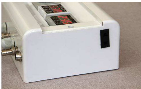
Фото 9. Розетка для подключения насоса или клапана водяного охлаждения
