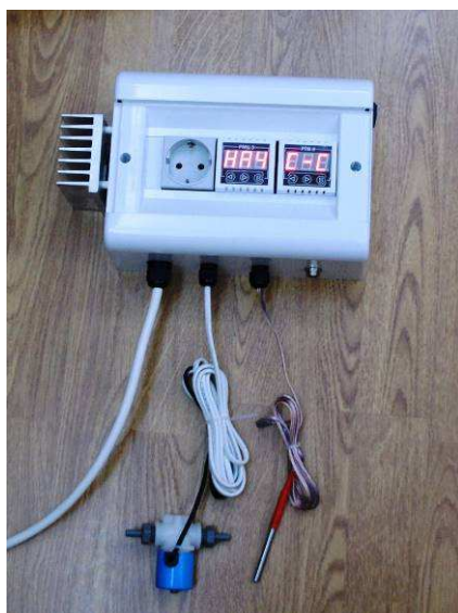
Фото 2. Внешний вид блока с датчиком и клапаном отбора
