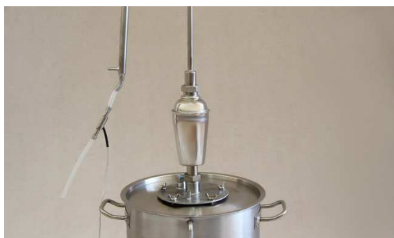
Фото 14 Датчик в режиме дистилляции
