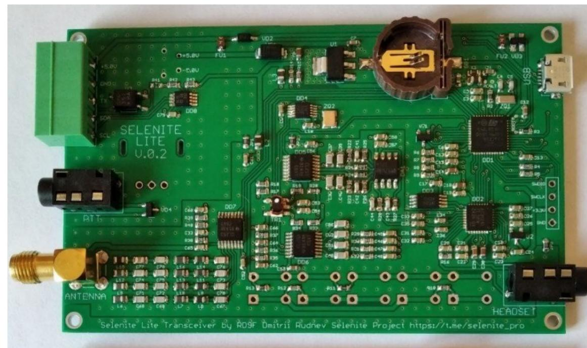
Справа расположены разъемы микро-USB (сверху) и микротелефонной гарнитуры (снизу). Слева расположены (сверху вниз): разъем расширения, разъем PTT и антенный разъем.
