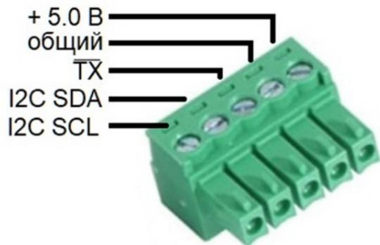
Разъем расширения служит для подключения к изделию внешнего стабилизированного источника электропитания постоянно-го тока с напряжением 5 В, передаче внешним устройствам сигнала переключения «прием/передача» и подключения внешних устройств к шине I2C изделия
