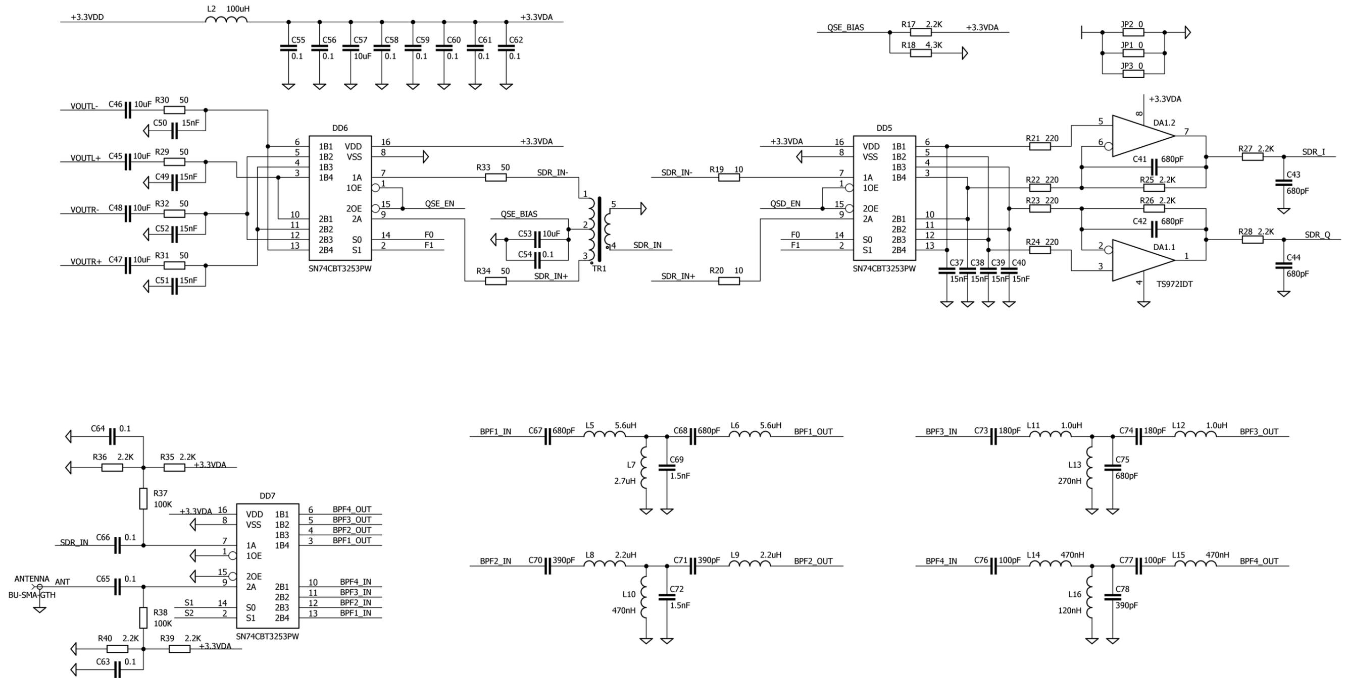
SDR трансивер Selenite Lite. Схема электрическая принципиальная. Лист 2/2
