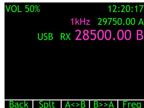
При нажатии кнопки «B>>A» значение частоты настройки VFOB будет записано в VFOA. При нажатии кнопки «A<>B» произойдет переключение гетеродинов.
