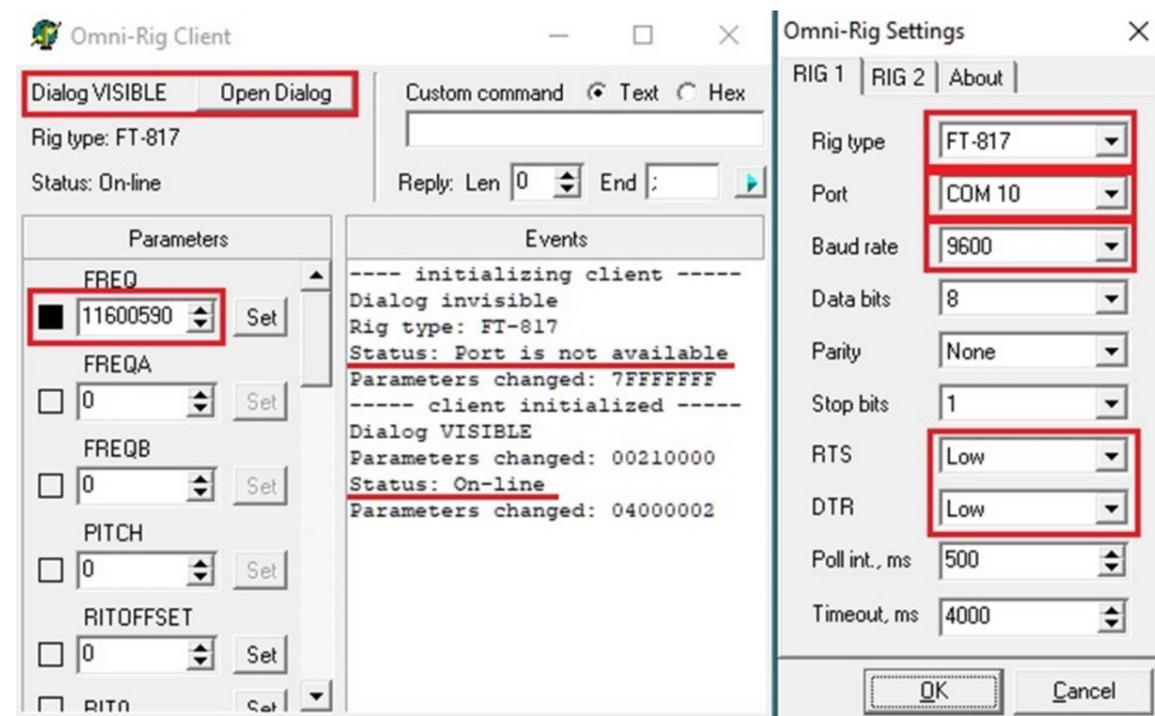
При правильной настройке параметров соединения статус подключения по CAT-интерфейсу должен измениться на «On-line».
