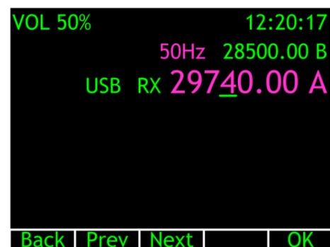
При нажатии кнопки «OK» производится выход с сохранением установленного значения. При нажатии кнопки «Back» – выход без сохранения.
