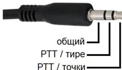
Разъем PTT обозначен на плате «PTT» и предназначен для подключения кнопки (педали) переключения «прием/передача» или телеграфного ключа. Диаметр разъёма 3.5 мм.
