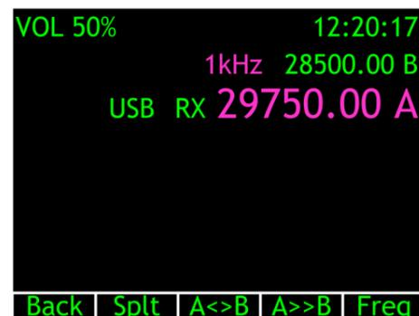
При нажатии кнопки «A>>B» значение частоты настройки VFOA будет записано в VFOB. При нажатии кнопки «A<>B» произойдет переключение гетеродинов, и экран будет иметь следующий вид:
