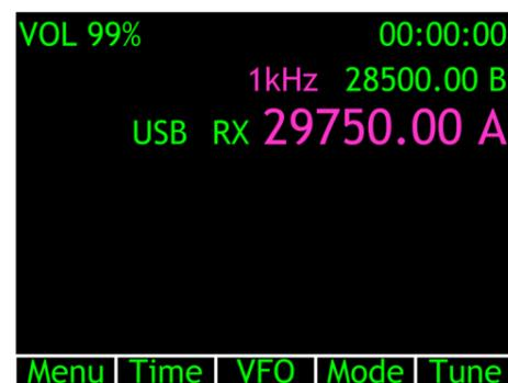
После нажатия кнопки «Tune» ручкой «Tune» производится изменение частоты настройки.
