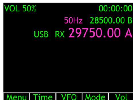
При длительном нажатии кнопки «Vol» ручкой «Tune» производится настройка шага изменения частоты. Значение меняется циклически в последовательности: ... 50Hz – 100Hz – 500Hz – 1kHz – 5kHz – 10kHz...
