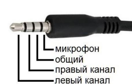
Разъем микротелефонной гарнитуры обозначен на плате «HEADSET» и предназначен для подключения стереофонических головных телефонов (наушников) или микротелефонной гарнитуры (гарнитуры), предназначенных для использования с мобильными телефонами и другой бытовой аппаратурой. Диаметр разъёма 3.5 мм.
