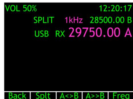
Ручная установка частоты настройки изделия осуществляется после нажатия кнопки «Freq». Переключение между разрядами производится кнопками «Prev» и «Next». Значение разряда устанавливается вращением ручки «Tune».
