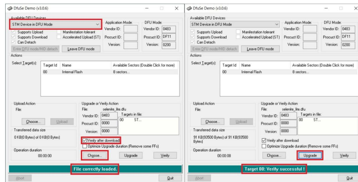
Выбор файла прошивки производится при нажатии кнопки «Choose...», загрузка содержимого файла в изделие производится при нажатии кнопки «Upgrade». Рекомендуется включить верификацию загрузки установкой опции «Verify after download».
