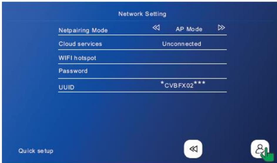
После перезагрузки устройство создаст точку доступа Wi-Fi
