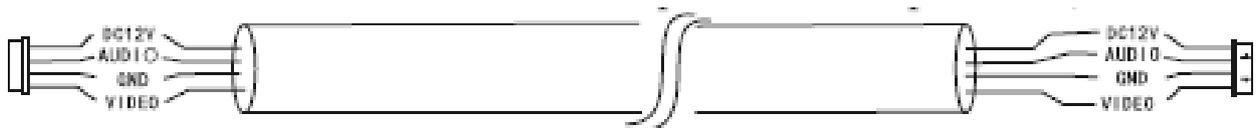
2. Для наилучшей передачи видеосигнала, а также при расстоянии более 50 м рекомендуется использовать коаксиальный кабель РК75 или кабель КВК-2×0.5.
