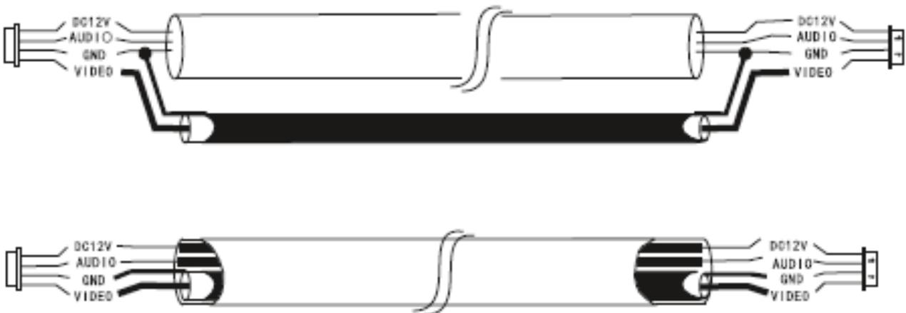
3. При использовании сетевого кабеля CAT5 или CAT6 расстояние между вызывной панелью и монитором будет ограничено. Для неэкранированного кабеля длина будет не более 20 м, для экранированного – не более 40 м. Но во избежание помех в изображении, этот кабель использовать не рекомендуется. Если вы всё же используете его, то использовать необходимо все 4 пары (2 провода одной пары используются, как один канал).
