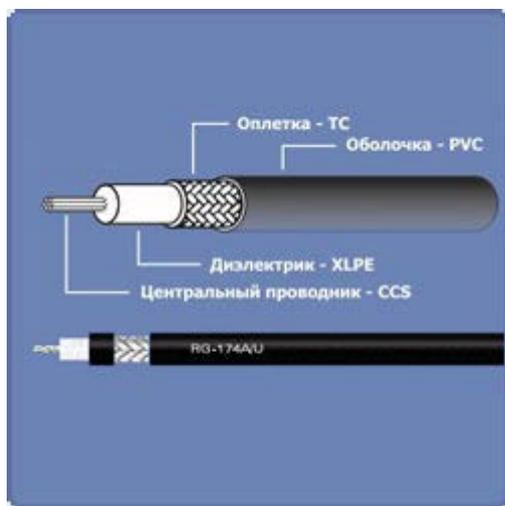
**Высококачественный радиочастотный коаксиальный кабель RG-174 A/U**, изготовлен с использованием диэлектрика из пероксидно-сшитого полиэтилена (cross-linked polyethylene - XLPE). ВЧ кабель также характеризуется низким затуханием и весьма стабильным значением КСВ (<1.2) в широком диапазоне частот
