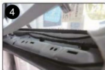
Подоткните кабель питания в зазоры между пластиковыми элементами (накладками) кузова и металлическими. Внимательно ознакомьтесь с местонахождением подушек безопасности в Вашем автомобиле и не допускайте попадания кабеля питания (и др.) на исполнительные механизмы подушек безопасности.
