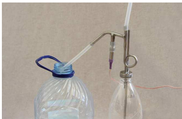
Фото 17. Датчик наполнения емкости в узле автоперевода отбора
