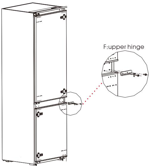
6) Отвинтите верхнюю петлю двери морозильной камеры и снимите дверь.
