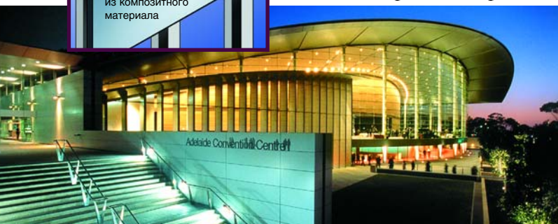
Дворец собраний в Аделаиде, Южная Австралия. Архитектор: Вудс Багот вместе со «Скидмор, Овингс энд Меррилл», 2001. Панель из алюминиевого композита приклеена к гальванизированной раме
