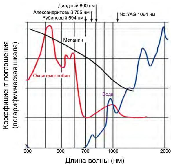
**Рис. III-2-1.** Зависимость коэффициента поглощения от длины волны лазерного излучения для различных хромофоров
