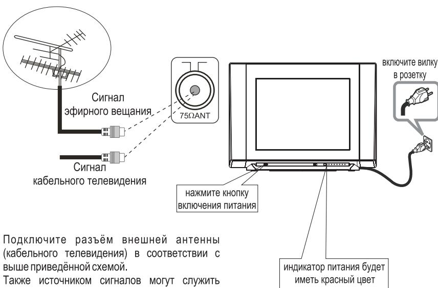
Подключите разъём внешней антенны (кабельного телевидения) в соответствии с выше приведённой схемой.
