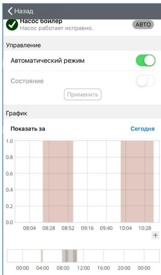
Настройка работы любого устройства из списка инженерного оборудования заключается в задании режима работы в поле «Управление» - ручной или автоматический. В случае выбора ручного режима, в поле «Состояние» необходимо включить или выключить устройство, сдвинув переключатель в соответствующее положение. После внесения изменений в настройки необходимо их подтвердить, нажав на кнопку «Применить».
