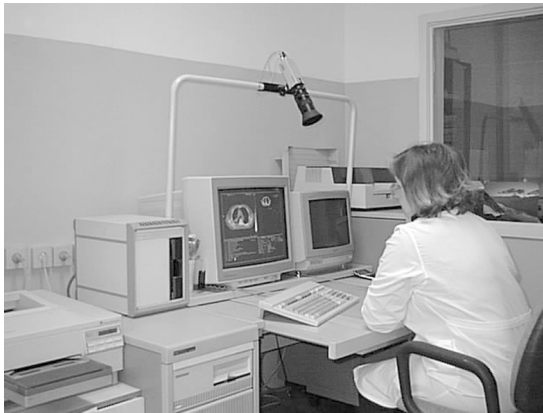
Рис. 2.9. Система планирования «CADPLAN». Позволяет осуществлять двухмерное или псевдотрехмерное (с помощью технологии beam's eye view) планирование ЛТ. Включает программу планирования, видеоматрифон, принтер, плоттер.
