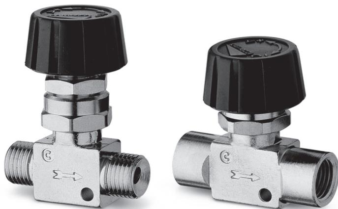
Вентили изготавливаются из латуни покрытой никелем, с уплотнениями NBR и пластмассовой регулировочной рукояткой. Они предназначены для регулирования расхода сжатого воздуха, воды и минерального масла. Мод. 2810, 2820, 2819 и 2829 возможно использовать для соединения с пластиковыми, медными и латунными трубками, используя гайку Мод. 1303 и наконечник Мод.1310/1320.
