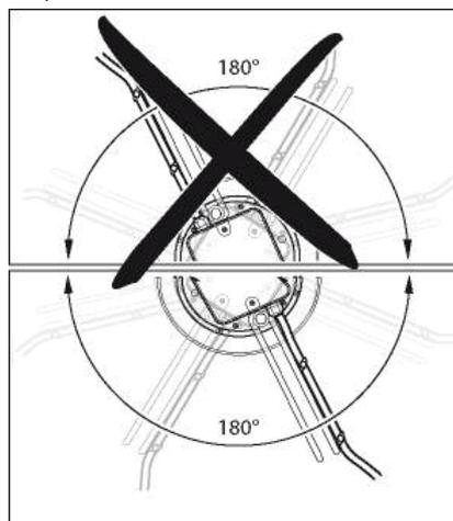
Иллюстрация 3: Прокладка кабеля при вертикально установленных вентиляторах.
