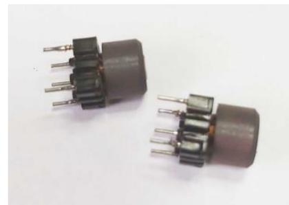
**Катушки полосового фильтра ФСС L5, L6, L7** имеют по 26 витков, а L8 – 4 витка поверх L7 проводом 0,16 и помещены в малогабаритные карбонильные чашки типа СБ-12. Частоты настроек контуров: L5,С5 - 6,25 МГц; L6,С9 - 6,0 МГц; L7,С13 - 6,5 МГц; При необходимости можно немного скорректировать конденсаторы С5, С9, С13. Чашки СБ12 между собой следует приклеить спиртовым клеем (например, БФ-2). Внимание! Не использовать ацетоносодержащие клеи – он может испортить кольца.
