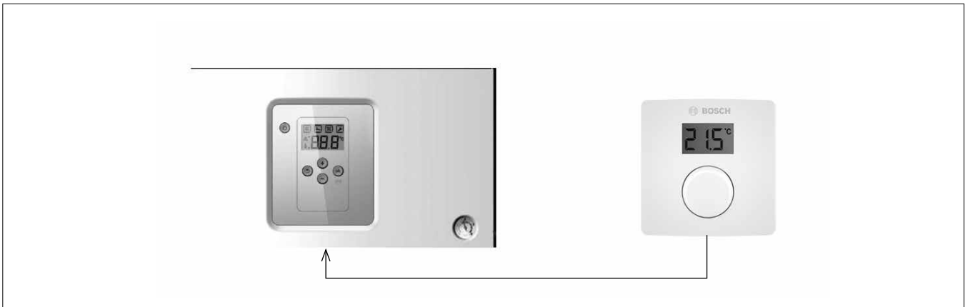
5/3 Комбинация регулятора комнатной температуры Open-Therm CR10 с панелью управления газового конвекционного котла Gaz 6000 W.
