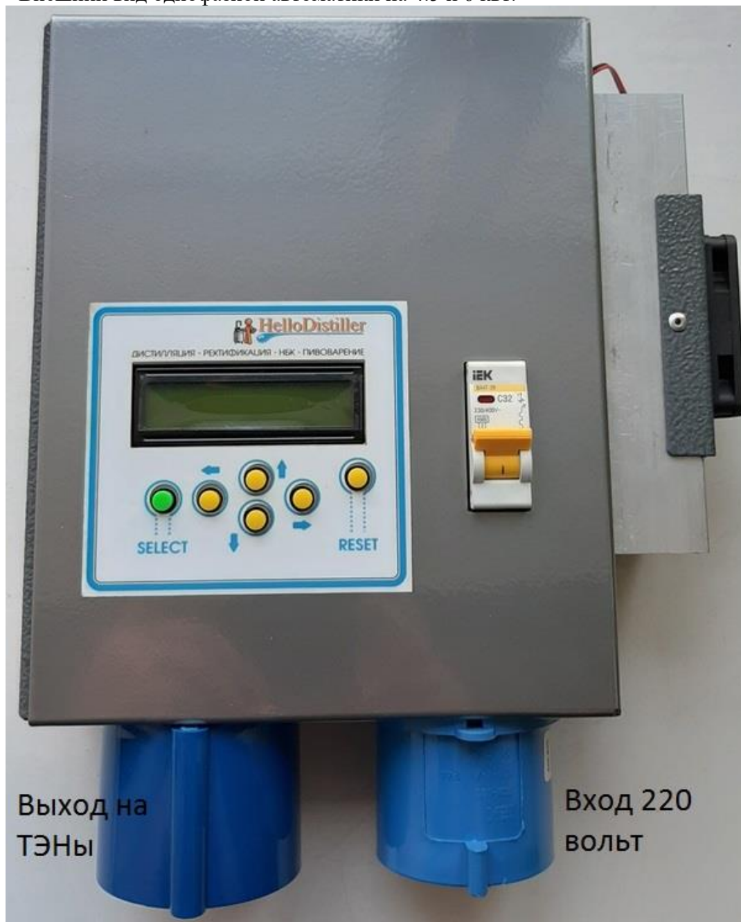
Внешний вид однофазной автоматики на 4.5 и 6 квт.
