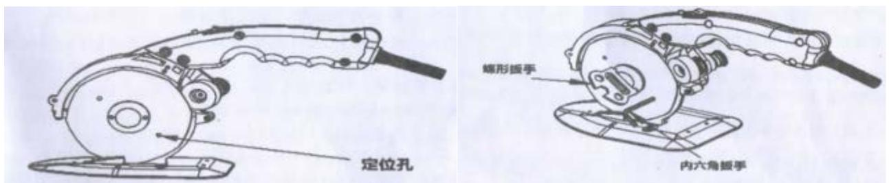
**Шаг второй:** используйте шестигранный ключ, вставьте его в диск, затем при помощи гаечного ключа в форме "бабочки" отвинтите пластины, прижимающие лезвие против часовой стрелки. Снимите лезвие.
