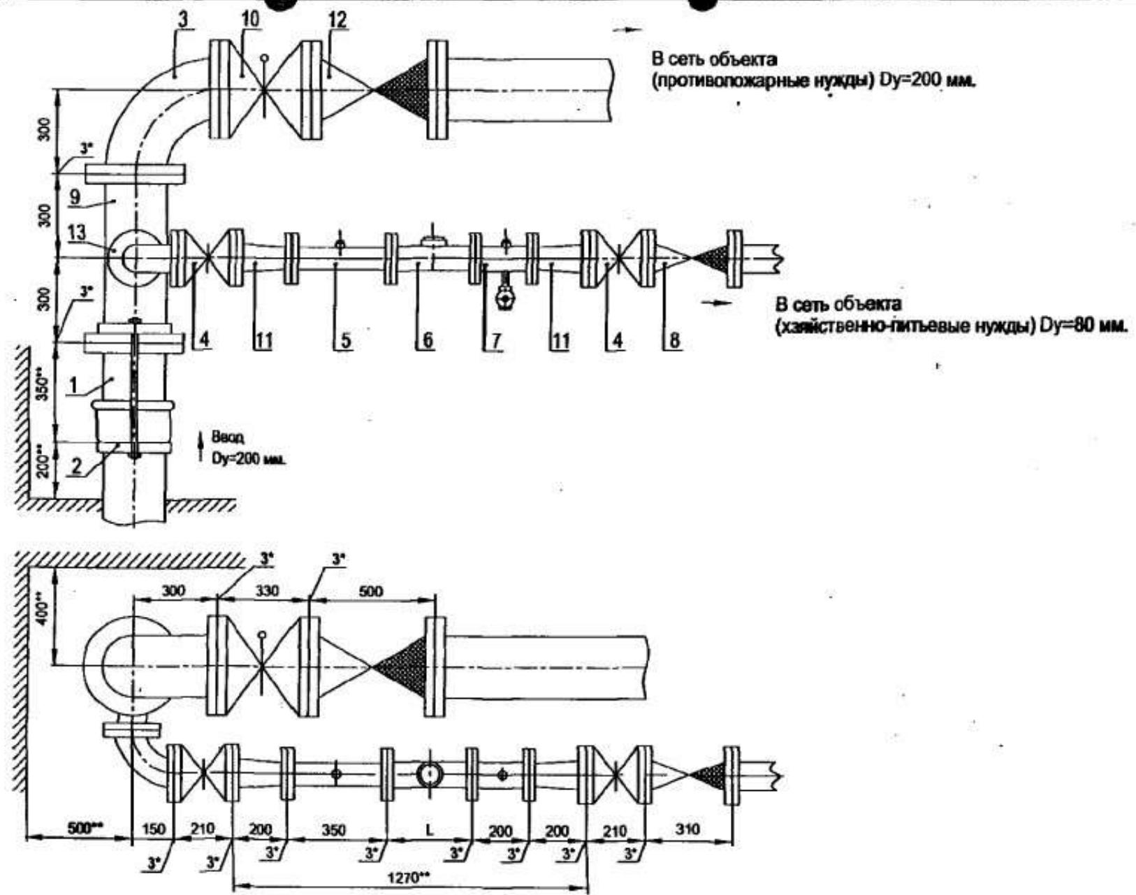
Установка счетчика  $Dy=65$  мм на хозяйственно-питьевой линии с раздельной системой хозяйственно-питьевого и противопожарного водопроводов на вводе диаметром 200 мм.
