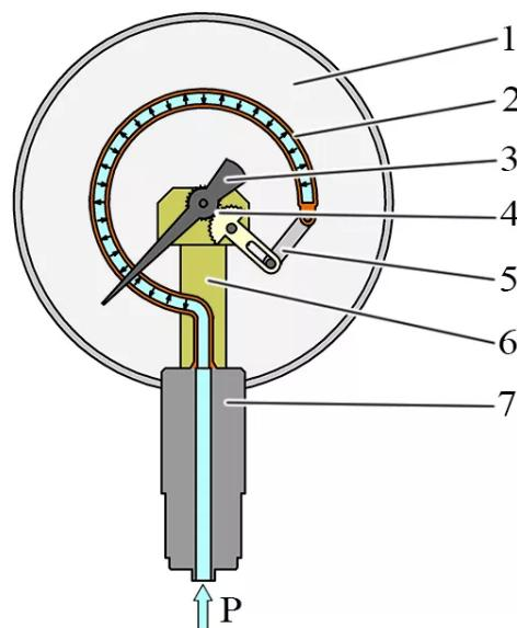
Основу прибора составляет медная изогнутая пружинная трубка овального сечения (трубка Бурдона) (поз.2). Рабочая среда поступает через присоединительный штуцер 7, выполненный из латуни CW614N, в трубку Бурдона. Под воздействием давления рабочей среды пружинная трубка меняет свою геометрию. Изменение положение заглушки трубки Бурдона по тяге 5 передаётся через трибко-секторный механизм 4 на ось стрелки 3, которая занимает соответствующее положение на шкале 1.
