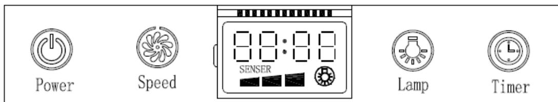
1. ВКЛ/ОТКЛ.: При включении питания загорается задняя подсветка и вытяжка включается в режиме ожидания. Задняя подсветка автоматически отключается через 5 с. Для использования вытяжки коснитесь любой кнопки.
