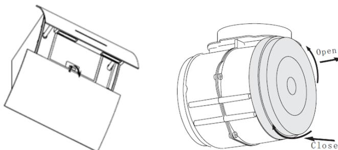
3. Поверните угольные фильтры, установленные с обеих сторон мотора, против часовой стрелки. Замените угольные фильтры на новые.
