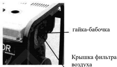
Не используйте моющее средство для мытья воздушного элемента. Когда мощность двигателя снижается или цвет выхлопных газов плохой, замените элемент фильтра. Никогда не запускайте двигатель без воздушного фильтра, так как чужеродные предметы могут попасть во впускное устройство и повредить двигатель.
