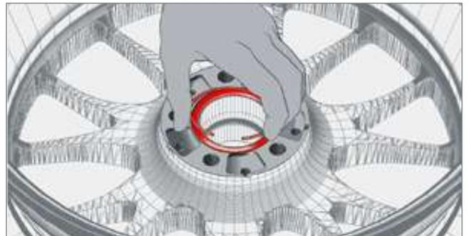
Nach richtigem Einbau befindet sich der Zentrierring etwas unterhalb der Anlagefläche und der Runddraht-Sprengring ist in der Nut eingerastet. Vergewissern Sie sich, dass sich der Zentrierring nicht mehr nach oben abziehen lässt.
