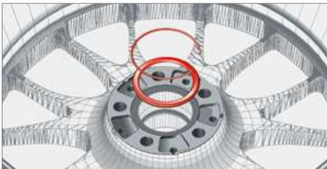
Setzen Sie den Zentrierring in die Nabenbohrung so ein, dass der Absatz des Ringes oben liegt.
