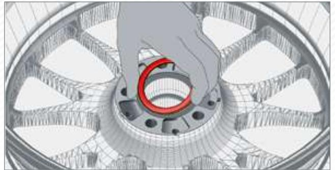
Drücken Sie den Runddraht-Sprengring leicht zusammen und lassen Sie ihn in den entstandenen Spalt zwischen Rad und Zentrierring einrasten.
