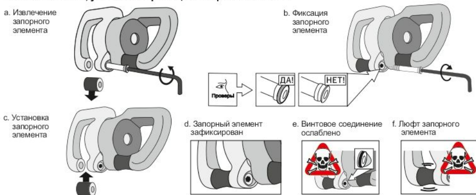
Рис. 4. Извлечение, установка и фиксация запорного элемента
