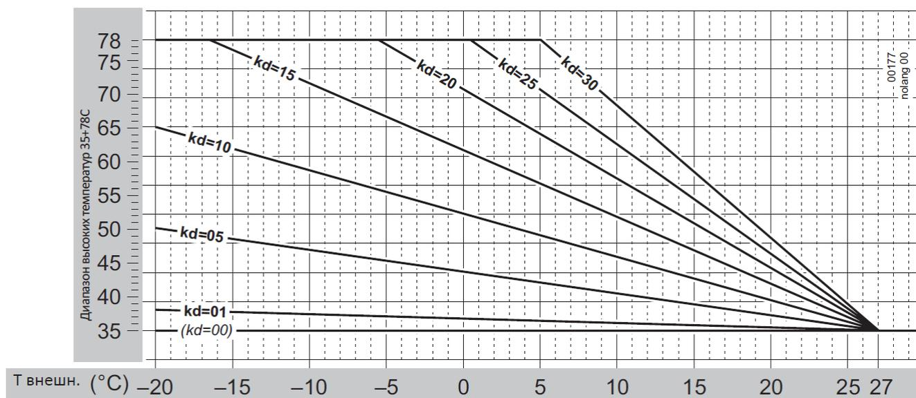
На практике, значение  $kd$  регулируется в зависимости от расчетного качества термической изоляции помещения. Диапазон его регулирования будет от 01 до 30: более высокие значения используются в случае высокой термической дисперсии и менее эффективной изоляции и наоборот.
