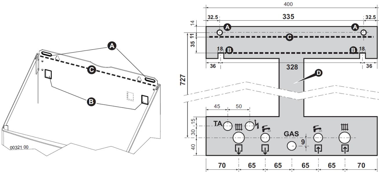
**Примечание:** Как дополнительная опция предлагается специальный бумажный шаблон одноразового использования (D на рисунке), облегчающий позиционирование точек крепления. Если не используется бумажный шаблон одноразового использования и / или оригинальный Комплект подсоединения, о позиции гидравлических подключений котла можно прочесть в параграфе «Габаритные и присоединительные размеры».
