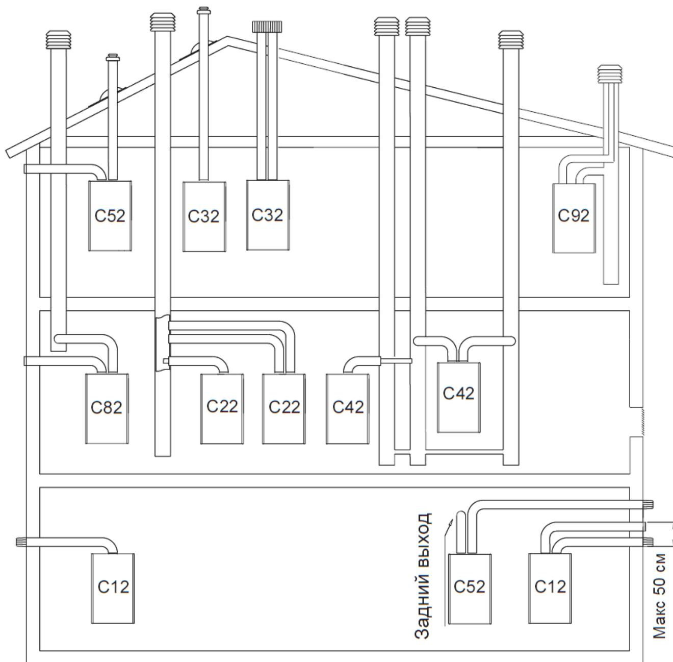
**C12-C12x** Выход дымовых газов через коаксиальные дымоотводы/воздуховоды. Дымоотводы и воздуховоды могут быть раздельными или коаксиальными. В случае использования раздельных дымоотводов/воздуховодов их выходы наружу должны быть расположены достаточно близко, чтобы находиться в одинаковых ветровых условиях.
