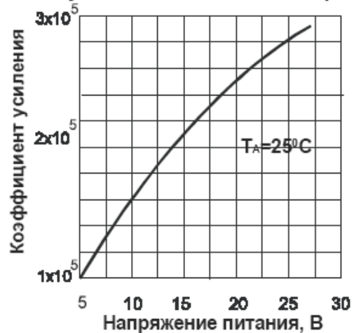
Зависимость коэффициента усиления от питающих напряжений
