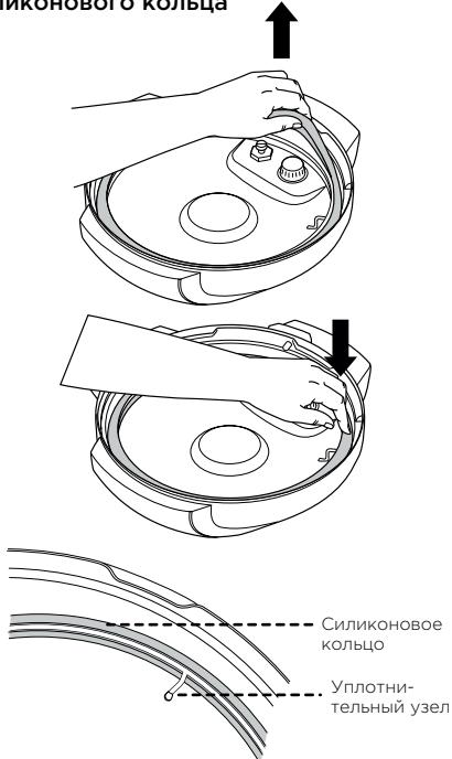
Для снятия силиконового кольца вытяните его наружу посекционно из уплотнительного узла. Кольцо можно устанавливать любой стороной. Для обратной установки посекционно запрессуйте кольцо в уплотнительный узел.
