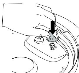
**ПРИМЕЧАНИЕ:** Перед каждым использованием убедитесь, что силиконовое кольцо лежит на уплотнительной поверхности надлежащим образом, а колпачок, предотвращающий засорение, правильно установлен на клапане сброса давления.
