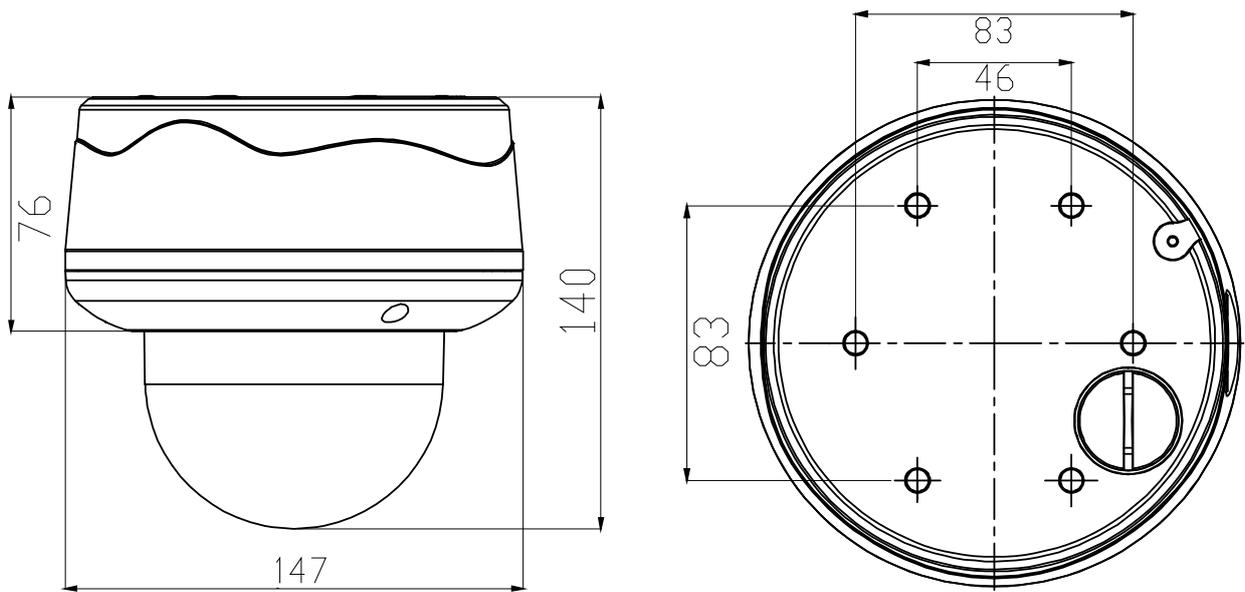
Рис. 6.1. Габаритные размеры LTV CNT-830 58
