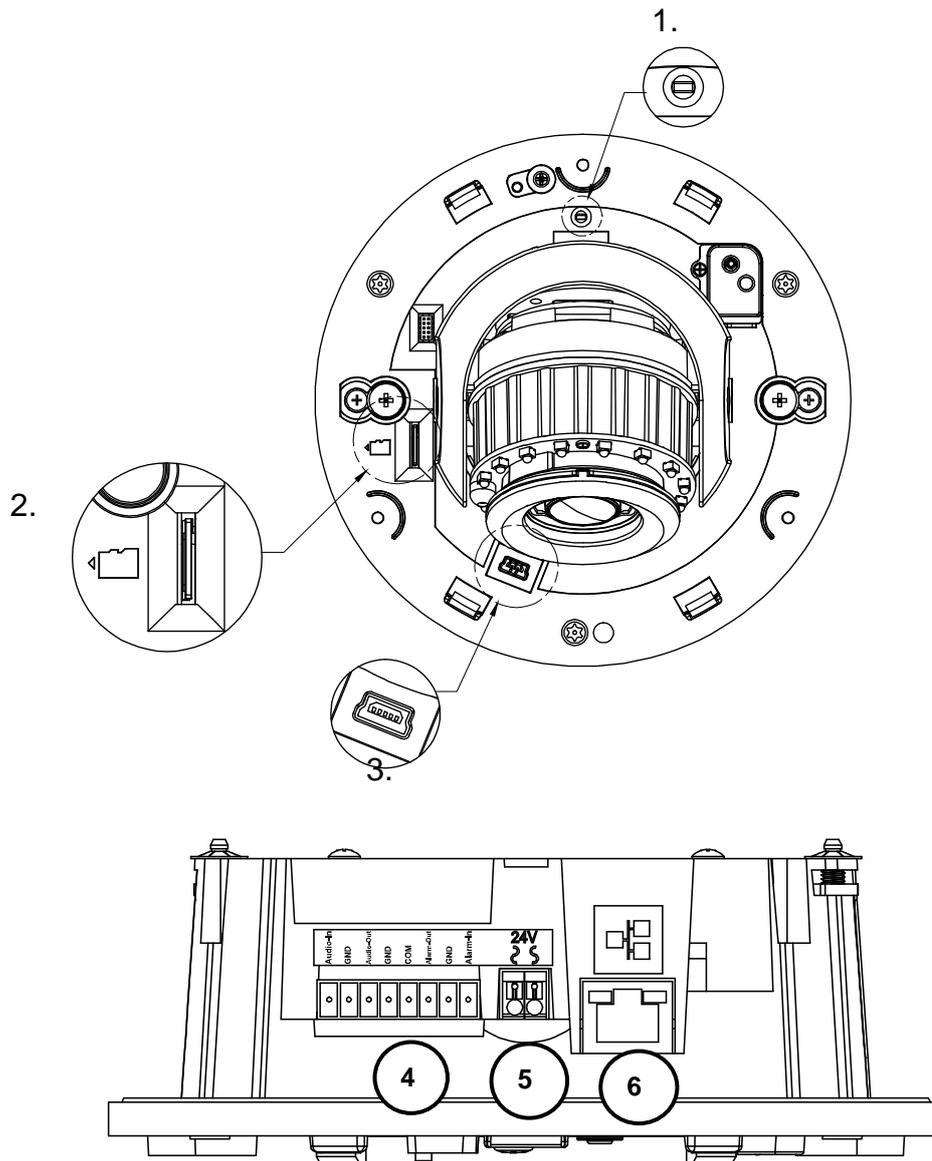
Рис. 3.1. Разъемы и кнопки управления видеокамеры LTV CNT-830 58
