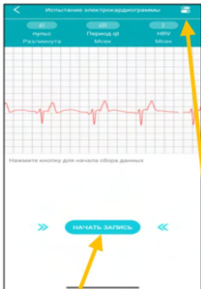
Старт снятия ЭКГ для регистрации данных. Без нажатия на данную кнопку, мониторинг будет производиться и будет работать сигнализатор, но не будут записываться данные в журнал
