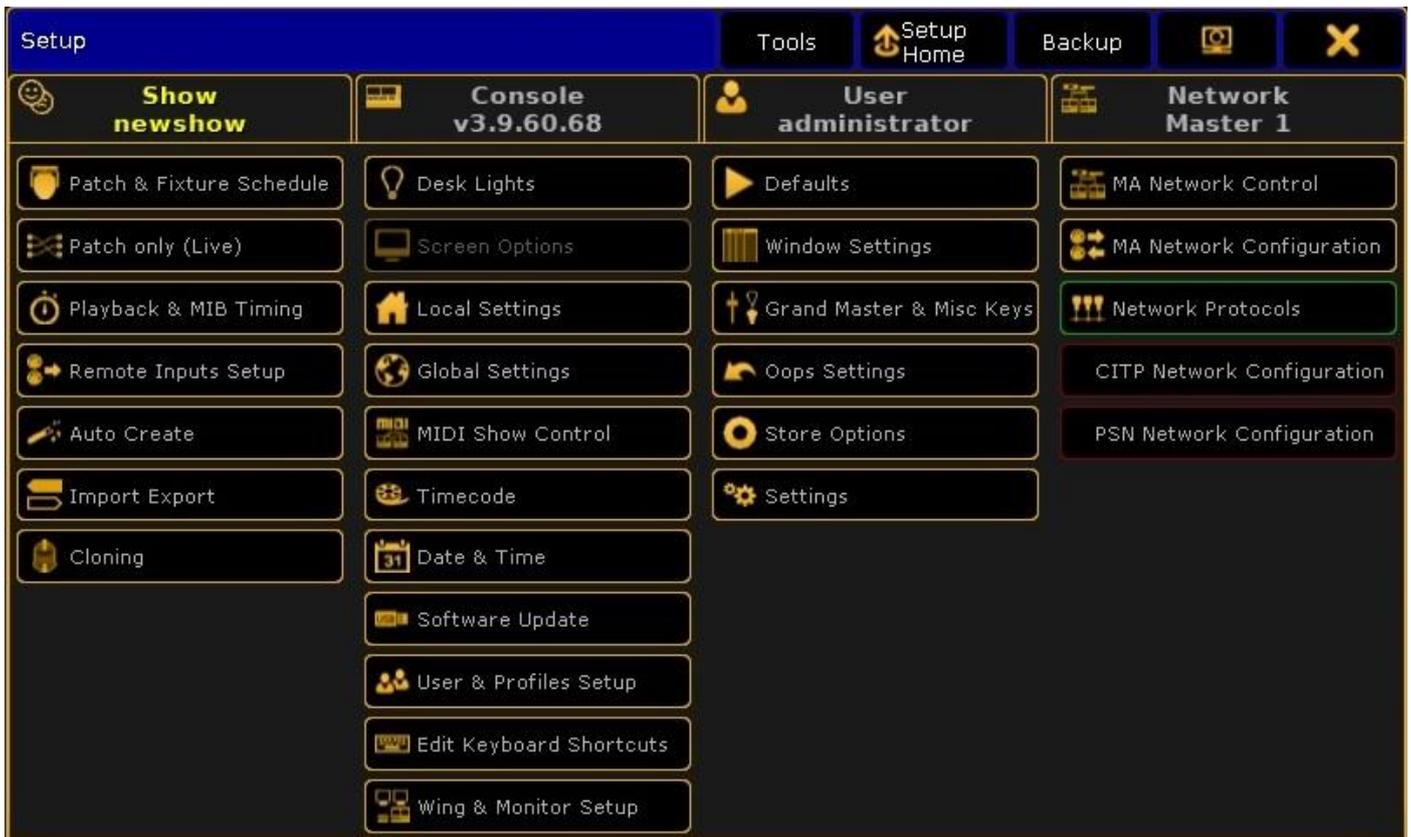
Нажав на кнопку "Wing & Monitor Setup", вы можете увидеть, какой эмулятор (fader или command wing) подключен. На картинке ниже - Fader Wing
