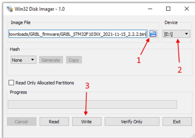
Рисунок 1: Обновление прошивки в Win32DiskImager
