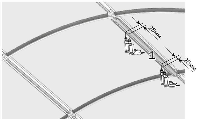
Вырезать поликарбонат по внутреннему контуру проёма каркаса. Установить петли
