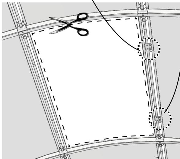
Установите по периметру выреза теплицы уплотнитель
