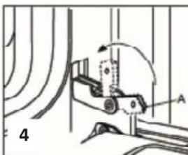
**Снятие дверцы духового шкафа** Поверните деталь А по направлению стрелки, как показано на рисунке 1.
