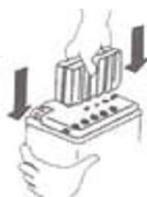
3. Переверните контейнер с электролитом вверх дном, установите его на батарею таким образом, чтобы выходы емкостей точно совпали с заливными отверстиями в аккумуляторной батарее.
