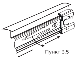
Рис. 2 Схема извлечения полки из корпуса тележки
