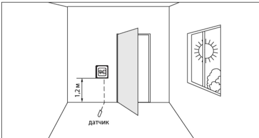
Подведите в гофротрубках питающие провода, соединительные кабели нагревательной секции, датчик температуры пола к монтажной коробке. Присоедините провода к клеммам терморегулятора согласно схеме, представленной на обратной стороне его корпуса.
