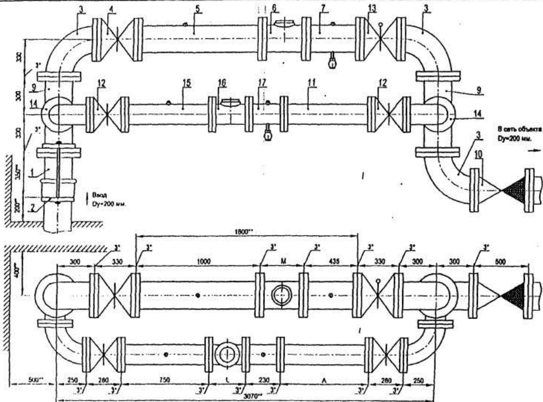
Установка счетчика  $D_{\text{у}}=150$  мм на хозяйственном-питьевой линии и счетчика  $D_{\text{у}}=200$  мм на пожарно-изолированной линии и водомерном узле на вводе диаметром 200 мм.
