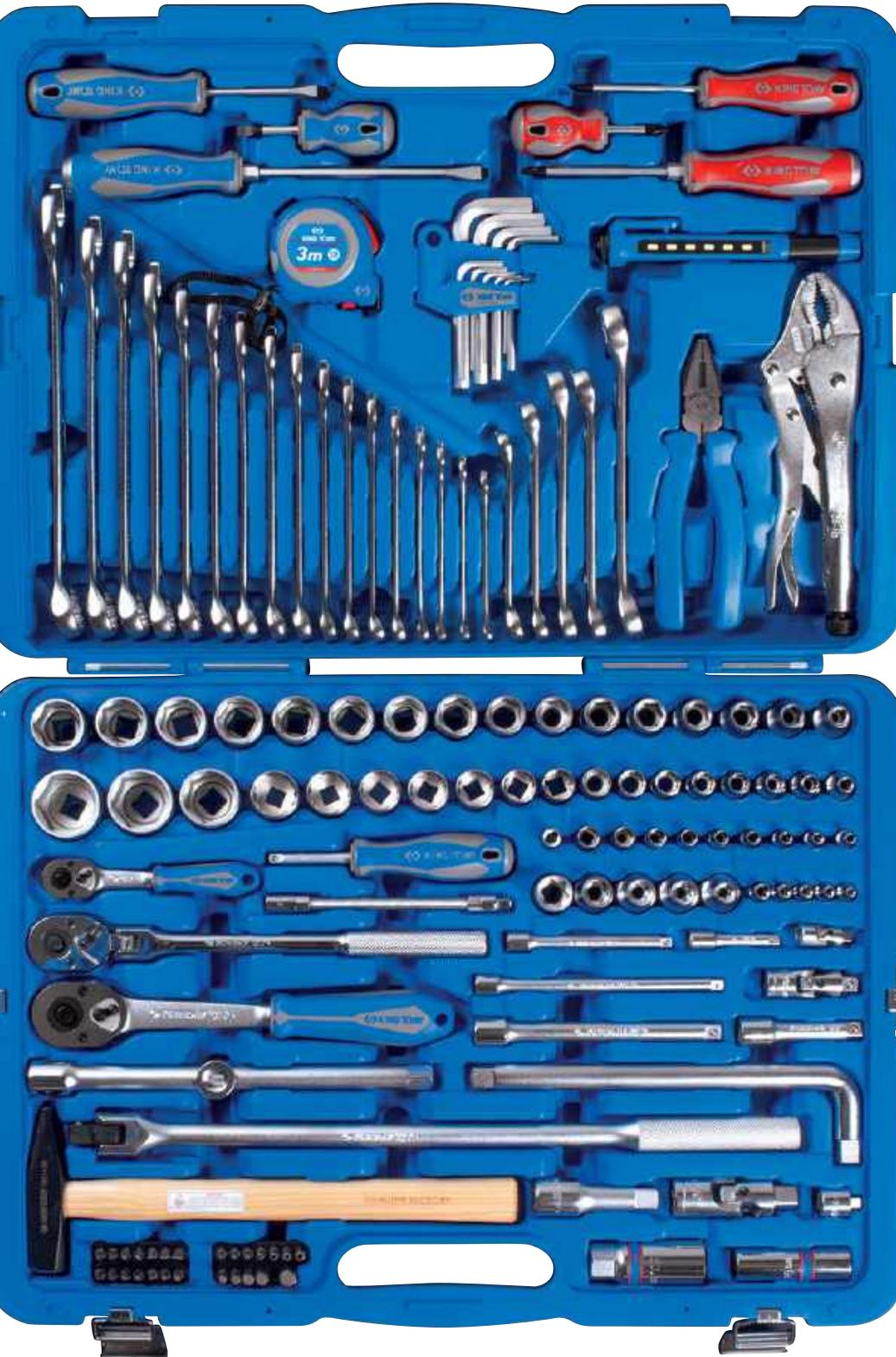
Особенность набора – 3 формата посадочного квадрата торцевых головок и принадлежностей к ним. Это дает возможность применения набора для обслуживания механизмов и техники разных габаритов и сложности, а поворотная трещотка 3/8" расширяет функционал набора при работе со сложными конструкциями и узлами. В комплектацию набора входит зажим с фиксатором – третья рука – незаменимый помощник для удержания конструкций, часто используется при сварочных работах.
