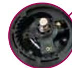
16-зубцовый механизм фиксации с возвратной пружиной
