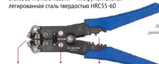
Снятие изоляции: 0.2-6 мм<sup>2</sup>    Кусачки, макс. сечение резки: 6 мм<sup>2</sup>    Опрессовка изолированных клемм: 0.5-6 мм<sup>2</sup>
