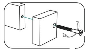
Перед монтажом крышки (№ 9), необходимо сначала соединить её с перегородкой (№ 18) евровинтом. Затем повернуть перегородку (направление 1) для крепления крышки и боковины (№ 11) евровинтами. После этого необходимо вернуть перегородку в нормальное положение (направление 2).
