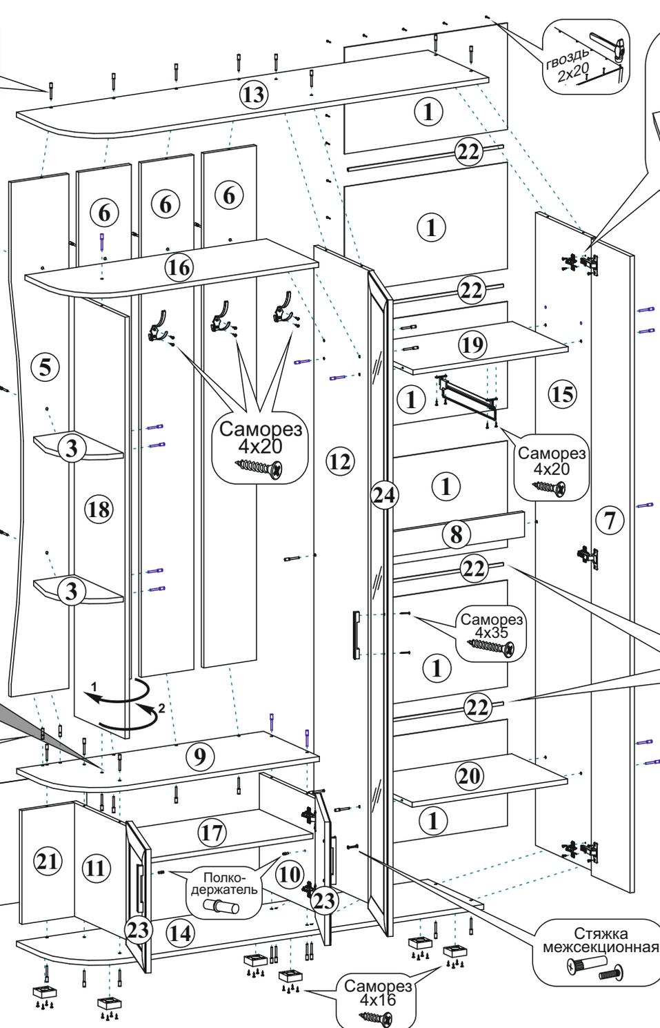
Сначала монтируются верхняя и нижняя петли, под которые есть разметка на боковинах, затем приворачивается средняя петля, под которую отверстия намечаются самостоятельно!
