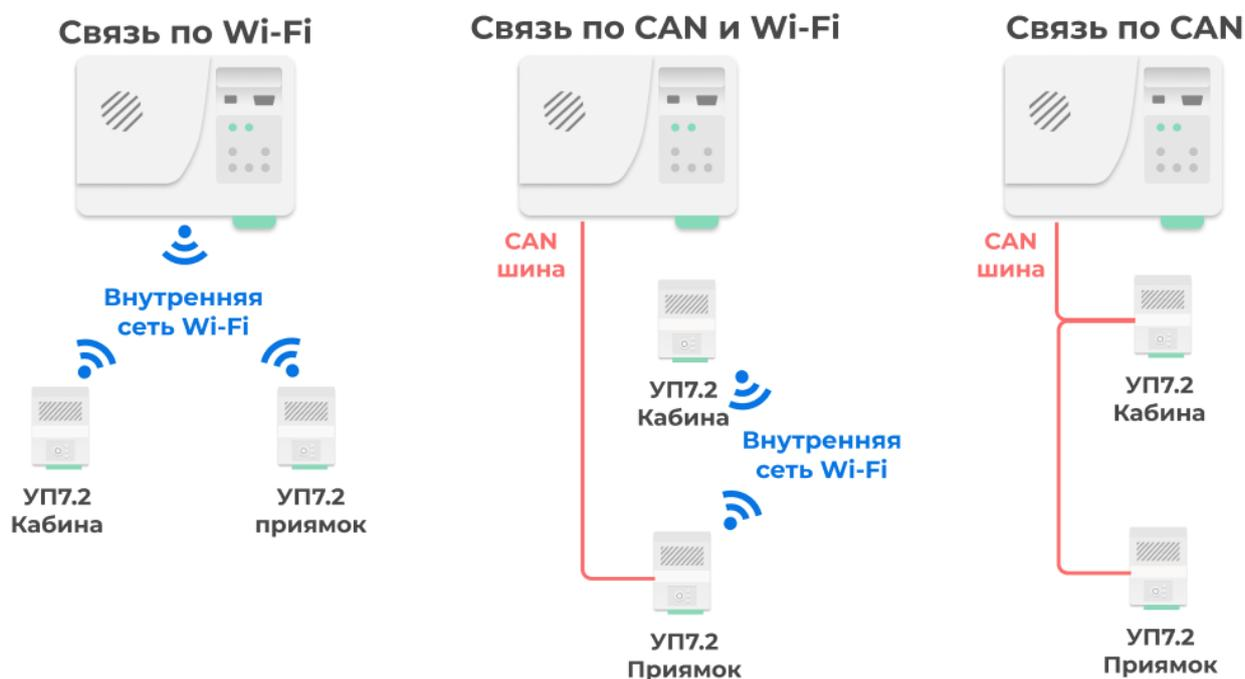
Рисунок 3 – Схема подключения УП7.2 к ЛБ7.2
