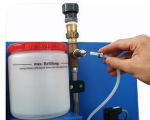
При первом заполнении ёмкости ароматического раствора автоматически воздух попадает в головку насоса. Для гарантирования надёжного функционирования насоса, необходимо удалить этот воздух. Для этого необходимо снять дозирующую трубку с дозирующего вентиля (см. рис.). При следующих наполнениях ароматического раствора удаление воздуха не требуется!
