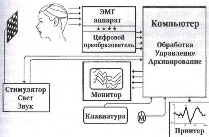
Рис. 3.2. Блок-схема регистрации ВП мозга
