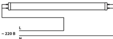
**Внимание!** Данная лампа предназначена для работы от сети 220 В без использования дополнительной пуско-регулирующей аппаратуры.
